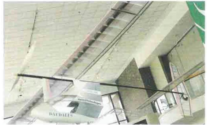
Abb. 4. Das Fluggerät Daedalus im Boston Museum of Natural History mit fußbetriebenem Propeller. Auch ein menschlicher Schwingenflieger wird eine ähnliche Konstruktion der Pilotenkabine haben müssen. Nur unter optimalem Einsatz der Beinmuskulatur kann der menschliche Körper die geforderte Leistung aufbringen, die in eine Schwingenbewegung der Tragflächen umgesetzt wird. [Photo mit freundlicher Genehmigung von John H. Lienhard, Houston University]
